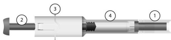
Figur 1. Injektionssprøjte med automatisk beskyttelsessystem af nålen
